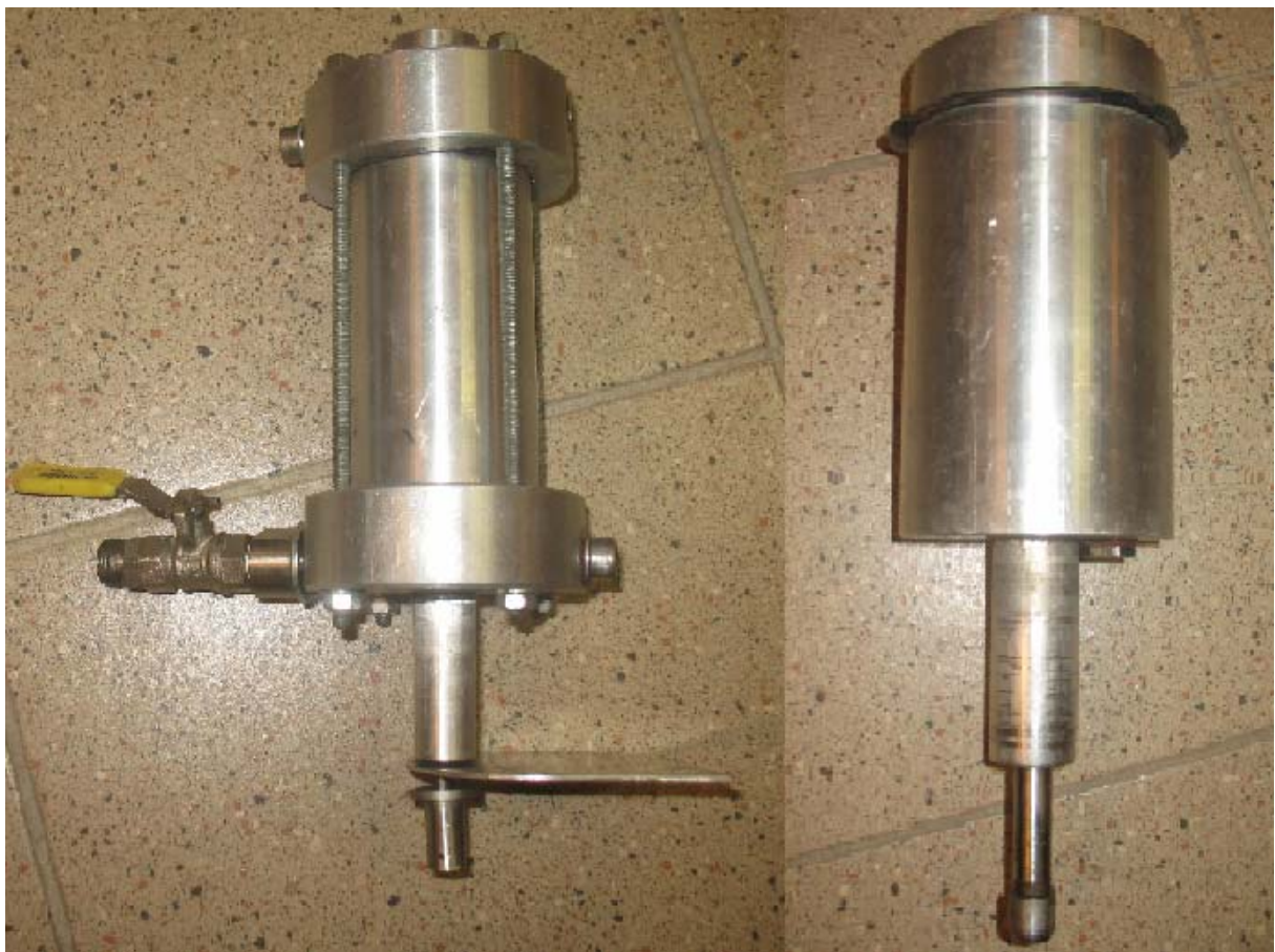
Figure II.8 : Schéma et vue du vérin hydraulique
