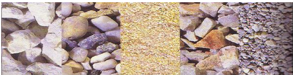
(a) (b) (c) (d) (e) Figure I.2 : Différents classes granulaires (a) Gravillon concassé, roche massive. (b) Gravillon roulé. (c) sable (d) gravillon concassé (e) grave concassé. (D'après Maillot, 2001)
