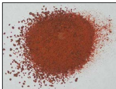
Figure 39 : décanoates de fer obtenus aux trois pH étudiés
