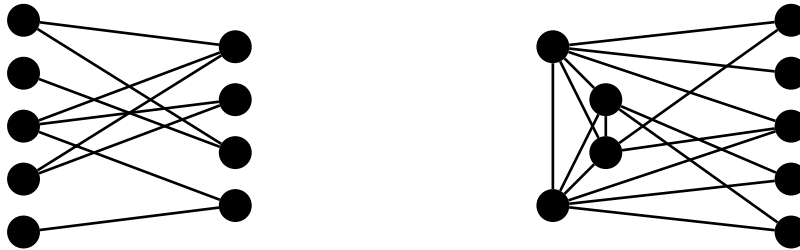
Fig. 1.3 – Exemple d'un graphe biparti (à gauche) et d'un graphe split (à droite).
