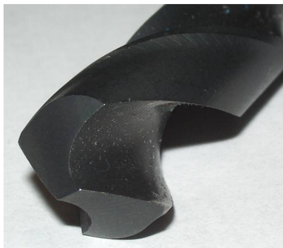
Figure 1. Foret hélicoïdal conventionnel ou classique.
