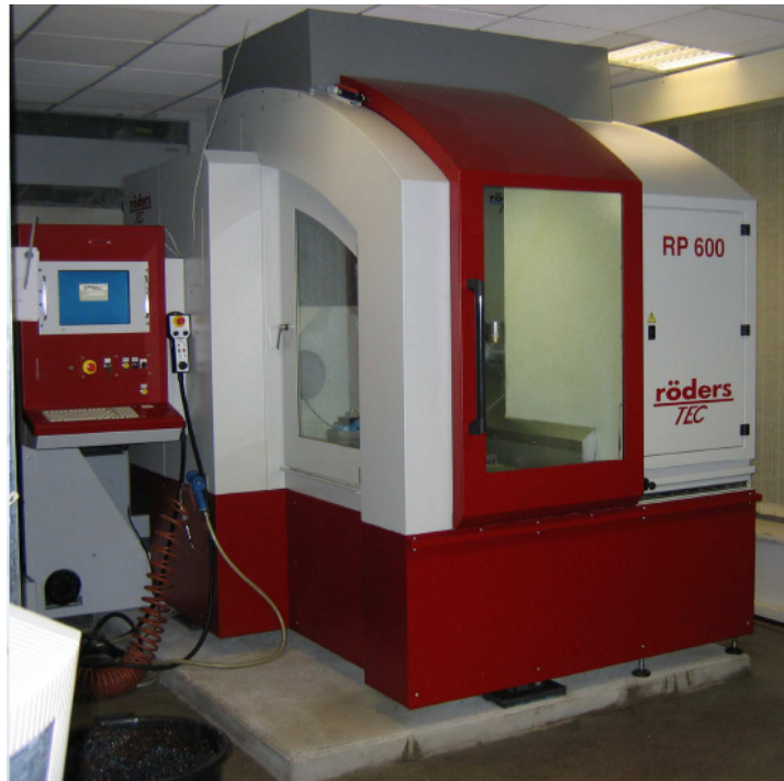
Figure 12. Centre d'Usinage 3 axes à Grande Vitesse Röders RP600.
