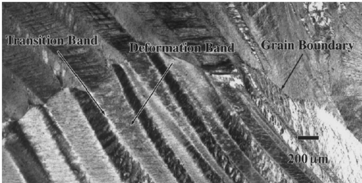
Figure I.6: Micrographie optique d'un alliage Al-Cu après compression uniaxiale à la température ambiante ( \sim 69\% déformation) qui montre une microstructure caractérisée par des bandes de déformation et des bandes de transition [Kulkarni98].
