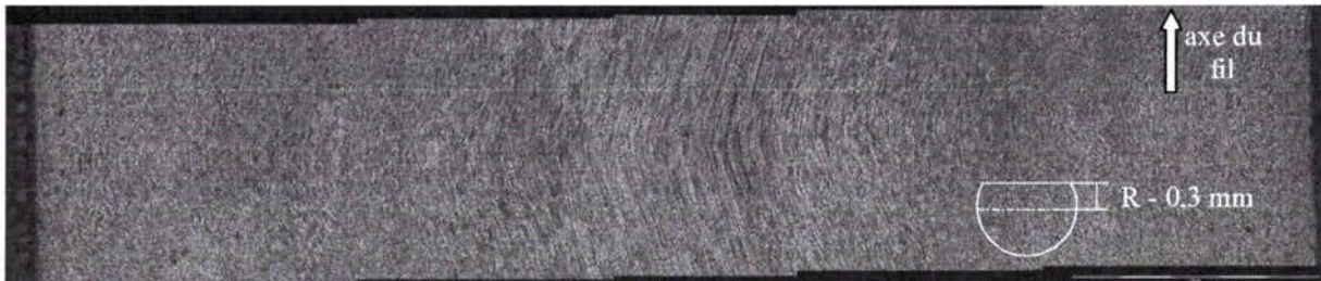
Figure III.52 : Front de déformation, R-0,3 mm. Axe du fil vertical (échelle = 100 \mu m)
