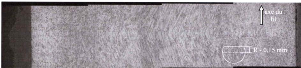
Figure III.51 : Front de déformation, R-0,15 mm. Axe du fil vertical (échelle = 100 \mu m)
