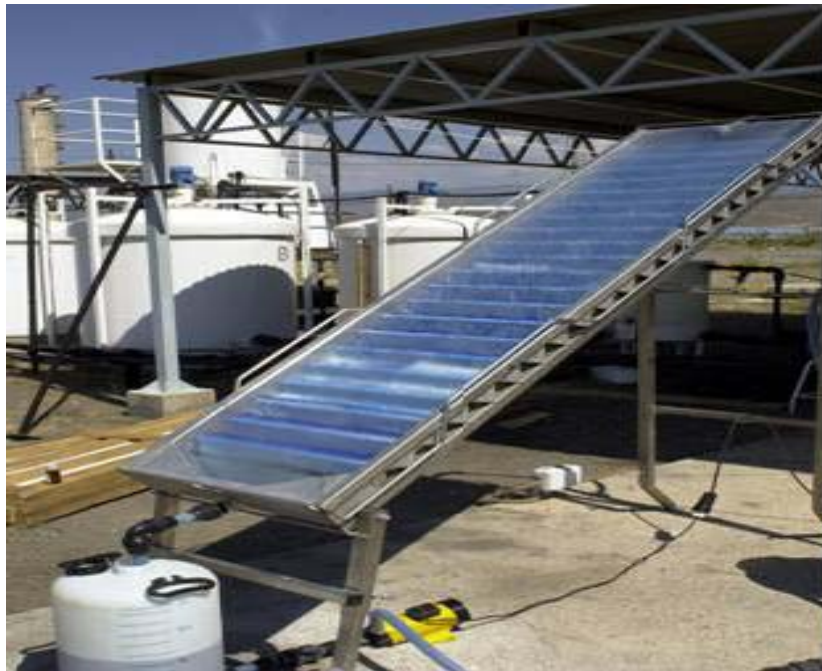
Figure I.18: Réacteur multi-cascade utilisant du \text{TiO}_2 immobilisé sur du nanier (plateforme solaire d'Almería - Espagne) [91]
