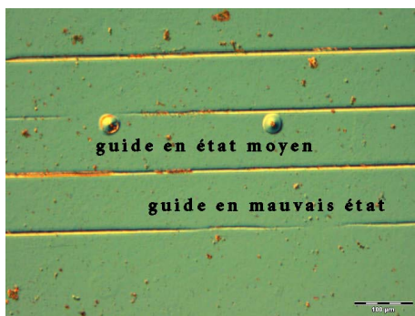
FIG. 3.17 – Photographie de quelques guides d'ondes en mauvais état et en état moyen
