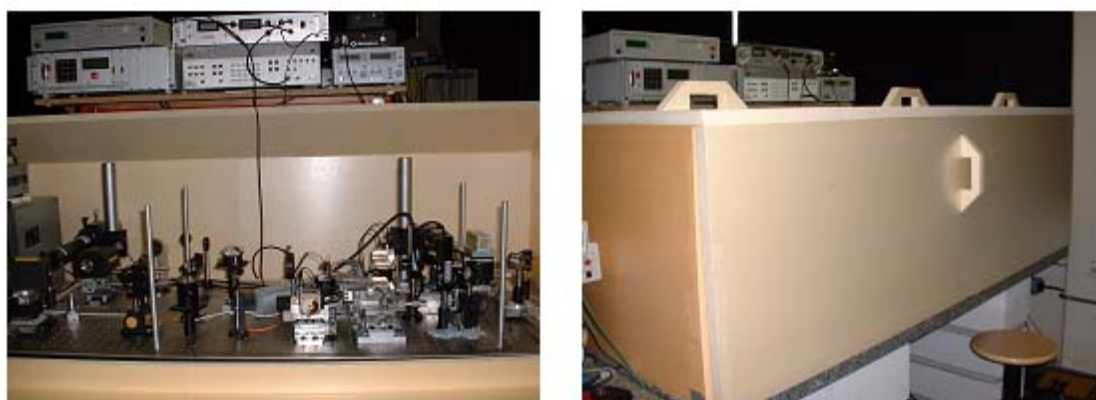
FIG. 3.10 – Double enceinte pour stabiliser la température
