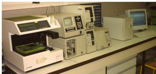
**Figure 113 : Photographie de la chaîne HPLC mise en place au LSMCL**
