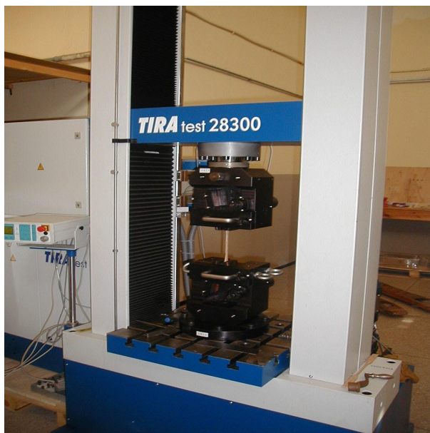
Figure 2.10: Montage d'essai sur éprouvette en traction.
