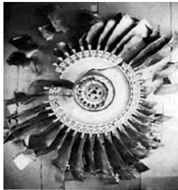
Figure 11 : Disque reconstruit à partir des débris du crash de Sioux City 1989, avarie causée par la présence d'un hard \alpha [NTSB-90]
