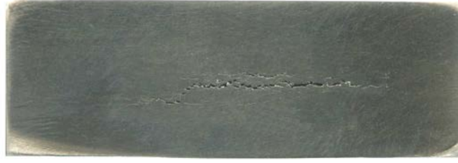
FIG. 2.8: Écaillage d'une cible de TA6V, V_{impact} = 300 \text{ m.s}^{-1} , L_i = 10 \text{ mm}
