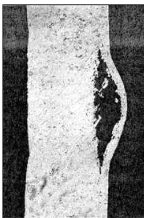
FIG. 1.30: Cible écaillée par impact laser, [Boustie, 1991]
