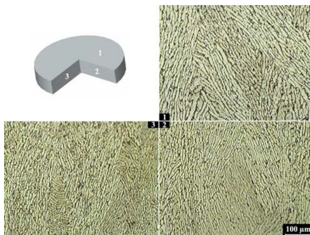
FIG. 1.13: Micrographies optiques de la structure de la cible dans trois directions orthogonales
