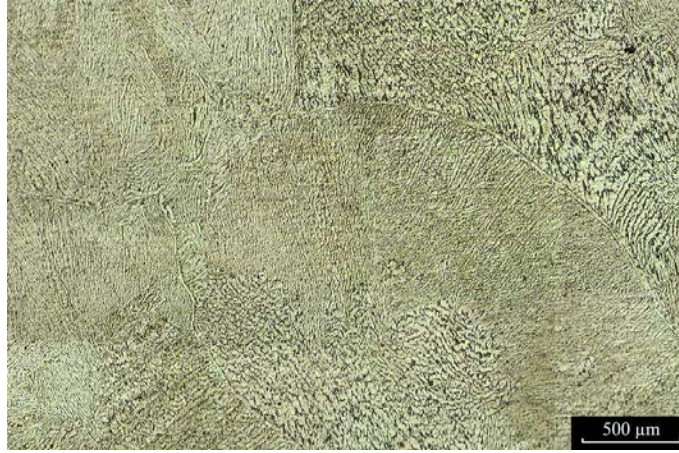
FIG. 1.15: Micrographie d'un grain \beta à l'intérieur duquel des colonies de lamelles \alpha se sont formées
