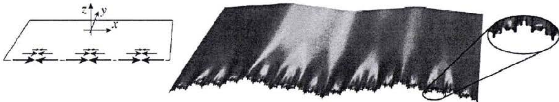
Fig. 3.14 : Flambage d'une plaque dû à un allongement résiduel près d'un bord : \varepsilon_{xx}=1/(1+y/l) , simulation numérique : épaisseur 2.9 \cdot 10^{-5} , largeur 1, l=0.08 (d'après Audoly et Boudaoud (2003)).
