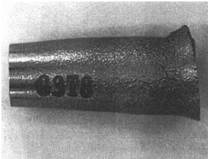
Figure IV-11 : Macrographie de l'échantillon Taylor en alliage G3 lancé à 506 m/s.
