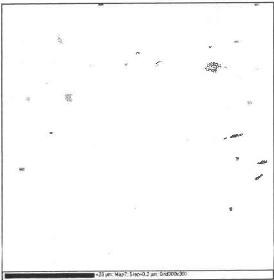
Fig. 5.2 : Cartographie de la phase austénitique
