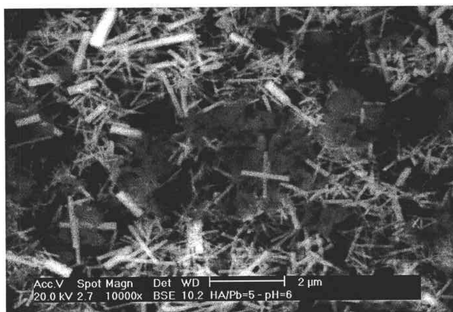
Figure 12 : Image au microscope électronique à balayage des produits de la réaction entre l'hydroxyapatite synthétique solide et le plomb, au rapport massique HA/Pb de 5/1, en mode BSE.
