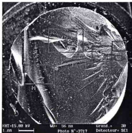
Figure (VII-11) : Vue globale de la surface de rupture; essai d'écaillage par impact de barres
