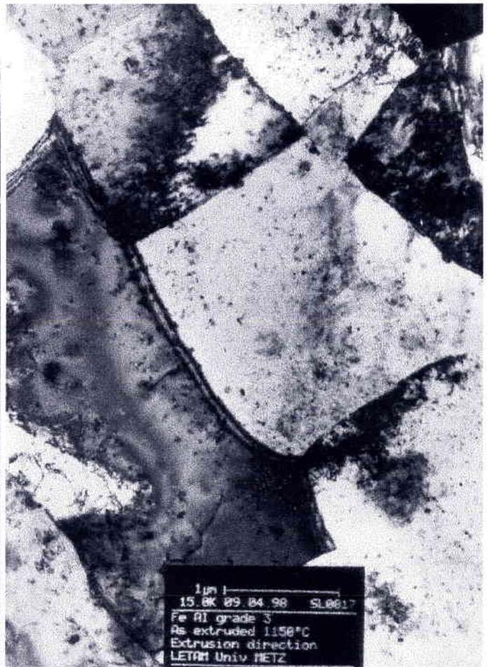
Figure III.1-6 : Be 1150 direction d'extrusion.
