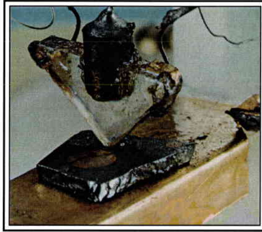
Figure 13 : Premier transistor inventé au Bell Laboratories [81Sze].
