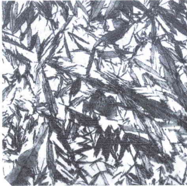
Figure II.8 martensite "isotherme" obtenue à T_h = 150^\circ\text{K} sous p_{\max} = 1,5\text{GPa} [UL90]
