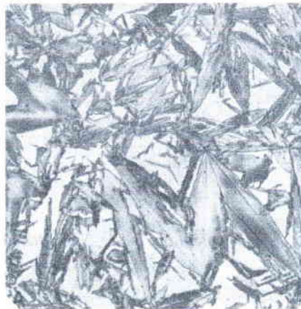
Figure II.7 : martensite athermal obtenue à la température T_q = 150^\circ\text{K} [UL90]
