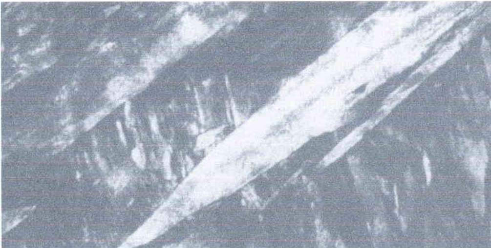
Figure II.5 : Micrographie d'une plaquette de martensite en latte . Observation au MET (alliage FE-0,4%C) [WA90]
