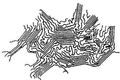
Figure I-11 : Modèle du micelle à franges
