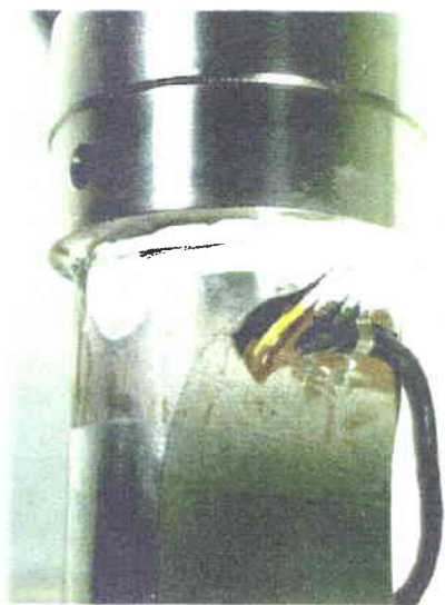
Figure 27 : Montage de la jauge sur l'ailette
