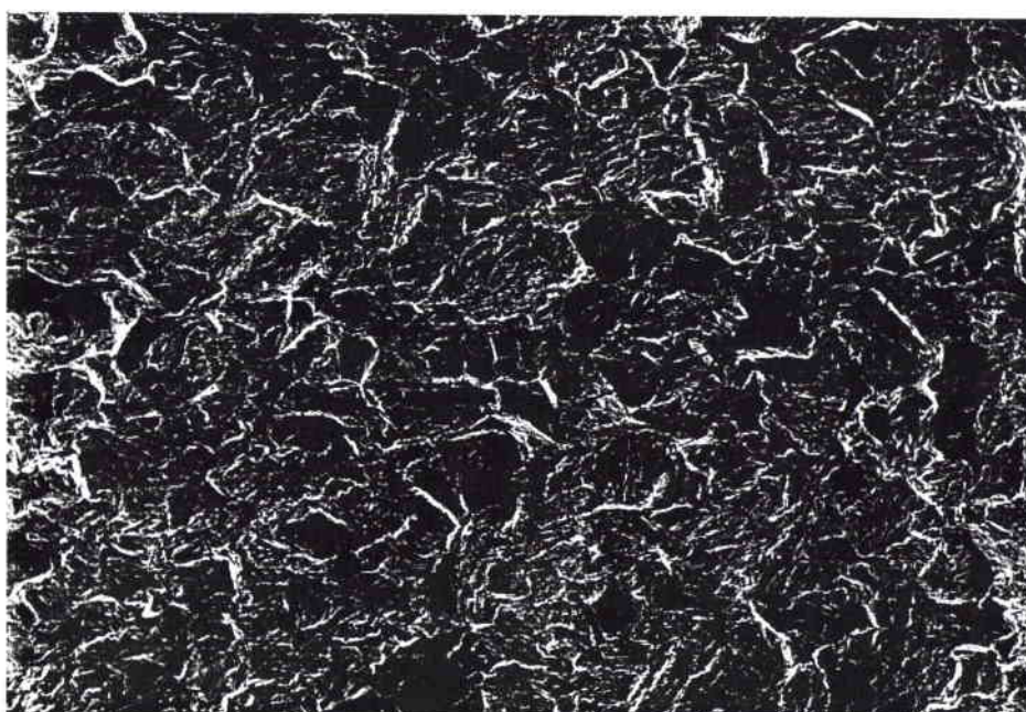
Figure 69 : Faciès de rupture en milieu aqueux ( G \approx 200 )
