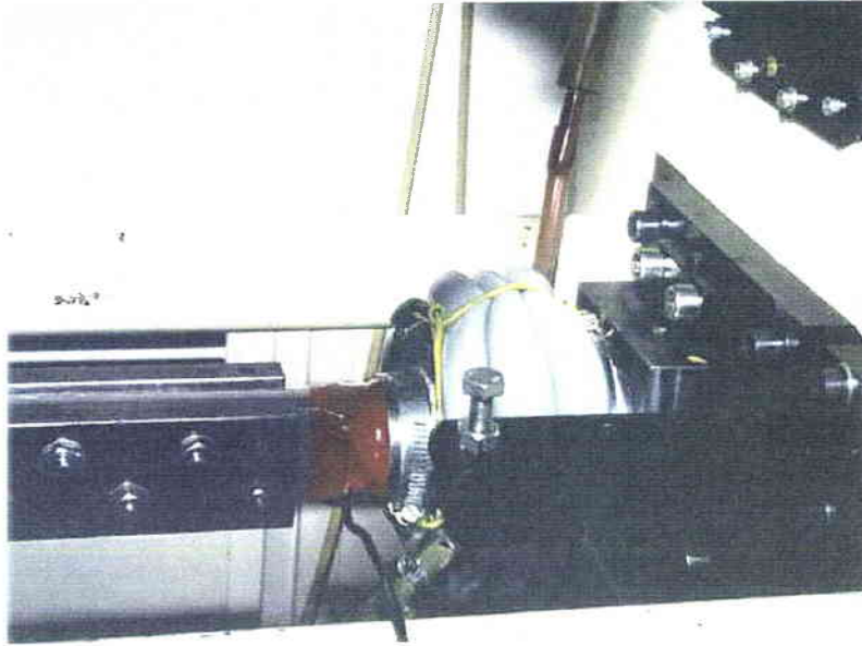
Figure 48 : Soufflet conçu pour la circulation de mélange H_2O + 1 \text{ g/l de NaCl} .
