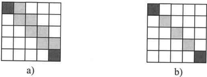
Figure III-16 : Chemins 4-connexe (a) et 8-connexe (b).
