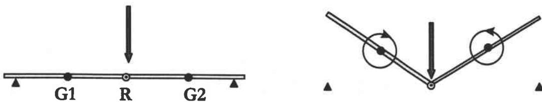
Figure 5-39 : Perte de contact aux appuis.
