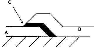
Fig. 1.3: Schéma d'une jonction SIS; A, B: supra-conducteurs; C: isolant d'épaisseur entre 1 et 5 nm.
