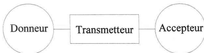
Figure I.2 : Représentation schématique d'une molécule « push-pull ».
