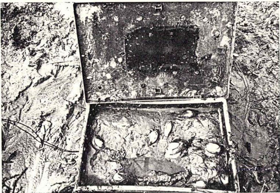
Photo 2.5 : Cage d'exposition (ouverte) des bivalves unionidés, Anodonta cygnea et Unio pictorum , et de la moule zébrée, Dreissena polymorpha , fixée sous le couvercle.
