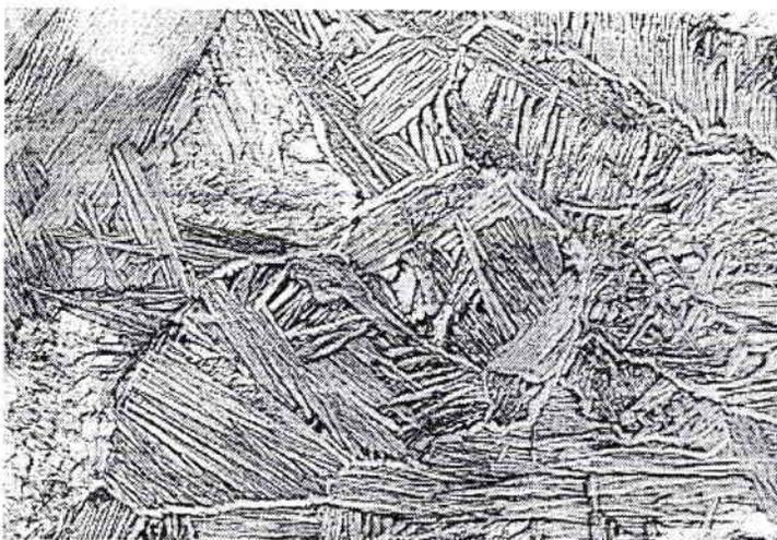
Fig. 3.3: Grains équiaxes observés dans l'échantillon RI
