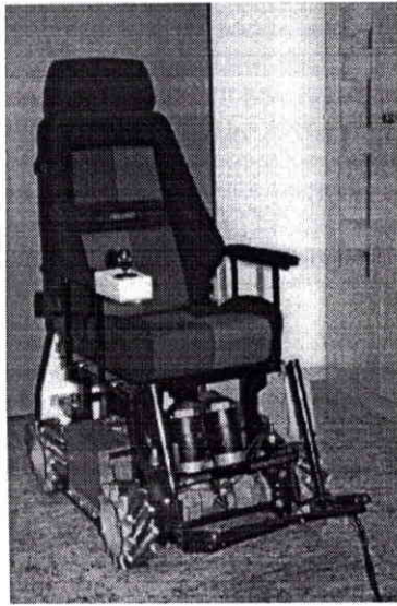
Figure II.11 : le projet OMNI et le système “Mecanum-Wheels”
