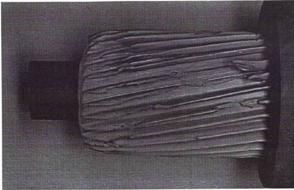
Figure 3.2 - Essai de filage-avant des pignons à denture hélicoïdale sur pâte
