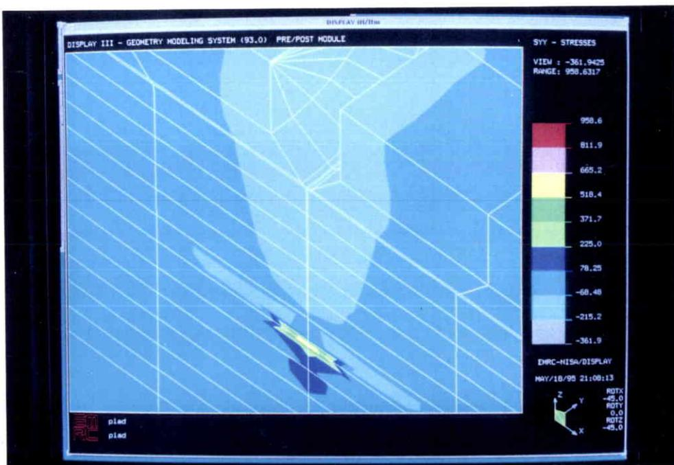
Figure A6. Concentration de contraintes au point le plus profond dans une plaque en flexion trois points
