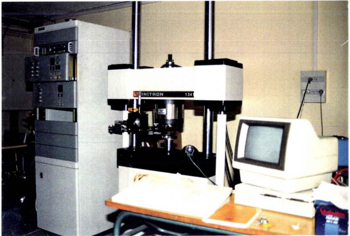
Photo 1. Machine de fatigue et dispositifs d'essais en mode II
