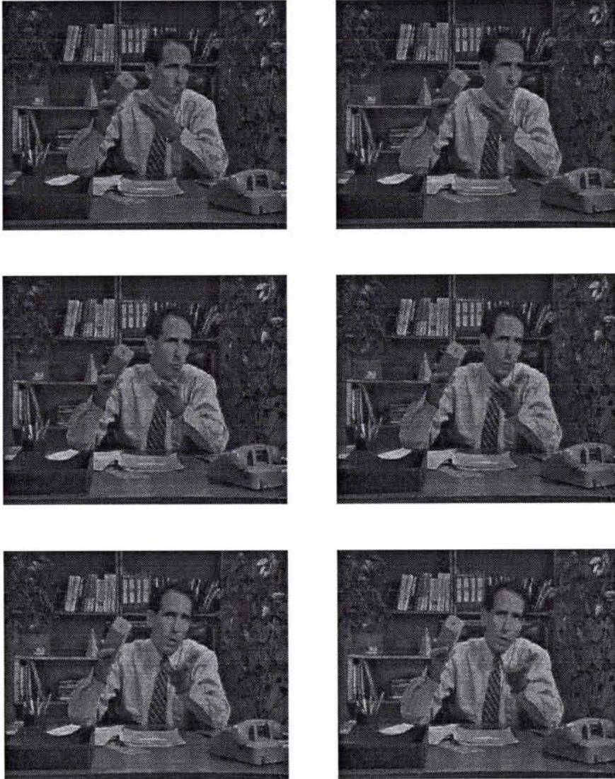
Figure 13.3 : Résultats du codage direct de séquence d'images (CIF) avec un débit moyen de 0.27bpp et un PSNR voisin de 30db.
