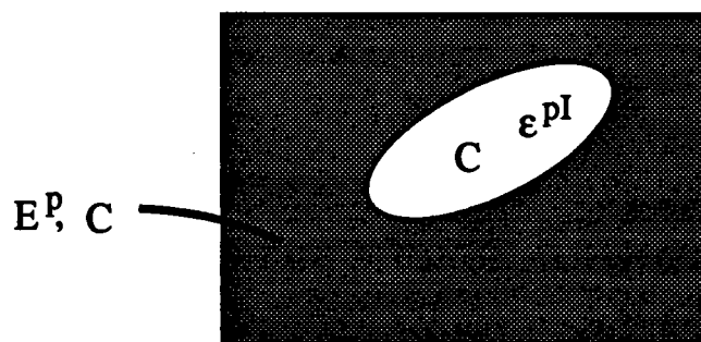
Figure V.1 : Problème de l'inclusion plastique
