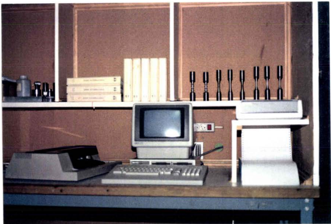
Figure 18 : Installation informatique pour le pilotage de la machine d'essai et l'acquisition des données
