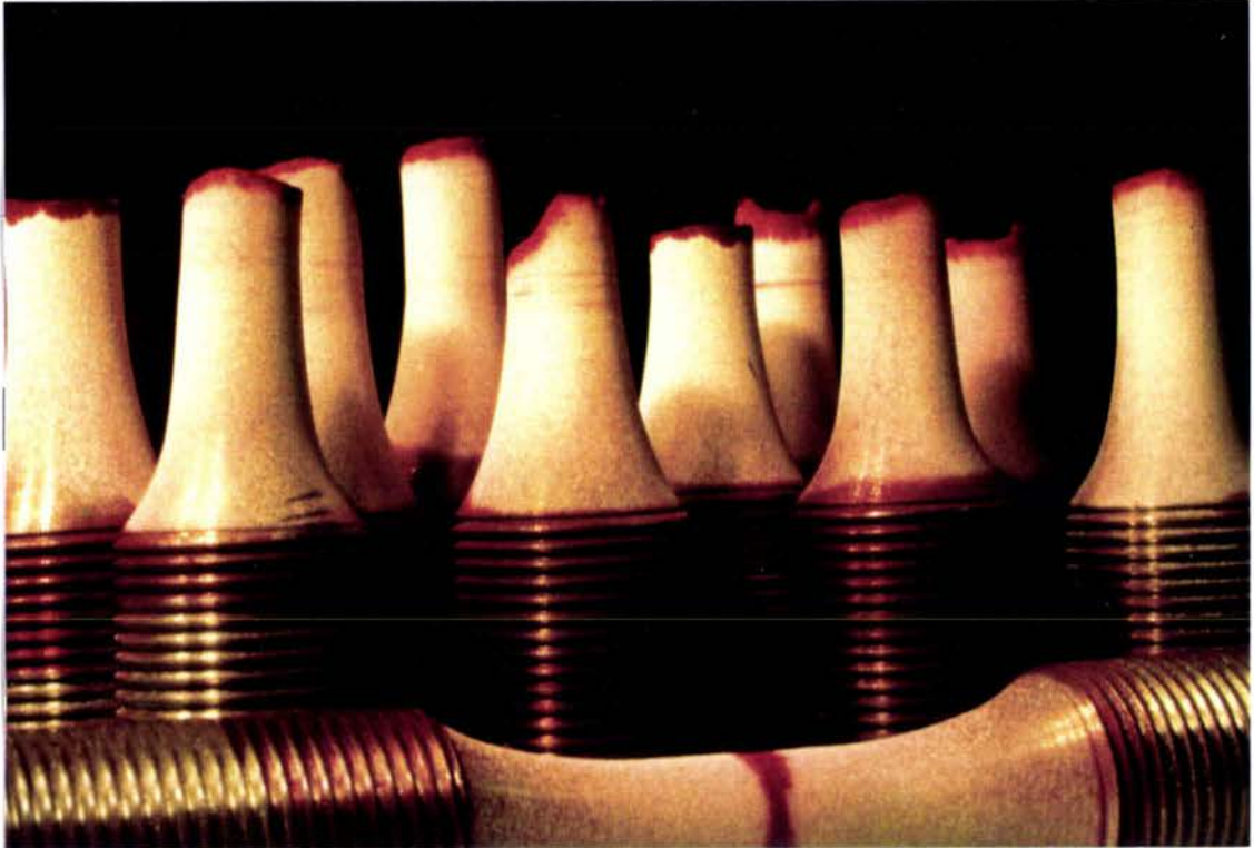
PHOTO 1 : Fissurations sur les éprouvettes à rupture en fatigue thermomécanique
