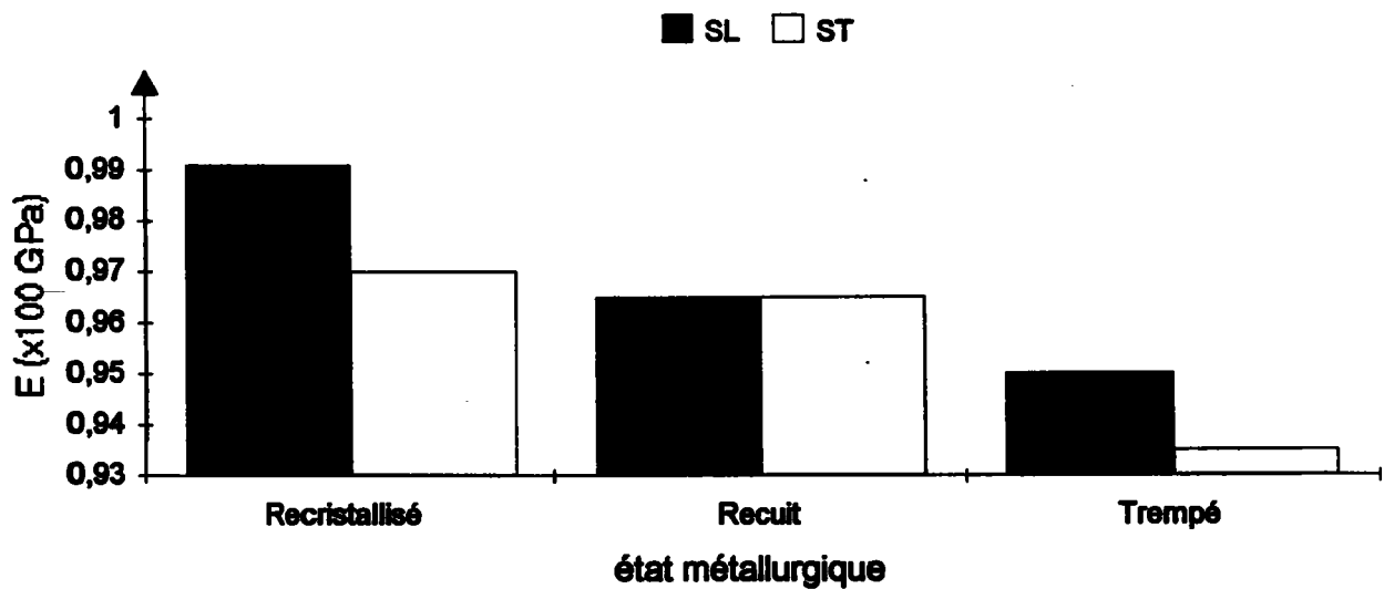
Figure I-12 : Influence de l'état métallurgique sur le module de Young du Zr 1 Nb 1 Sn 0.5 Fe
