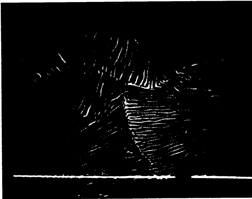
Figure n°3.2. Micrographie de la coupe longitudinale d'un fil d'acier XC 70 de 5,5 mm de diamètre. On remarque parfaitement la structure perlitique lamellaire de chaque grain. Grossissement : x 7500
