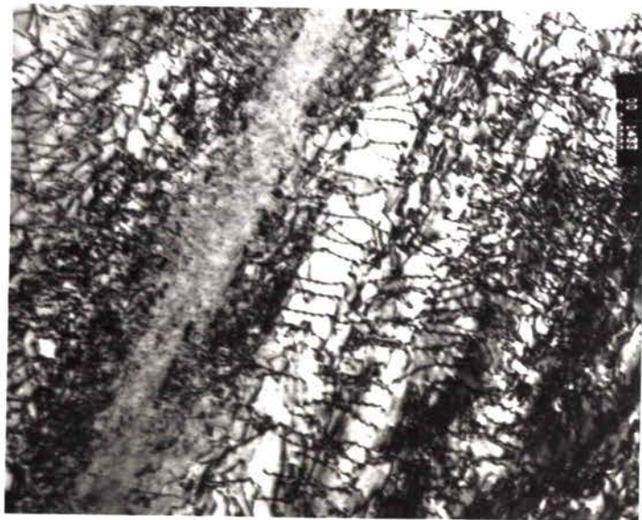
b - (x40 000) – Dislocations confinées dans leur plan de glissement
