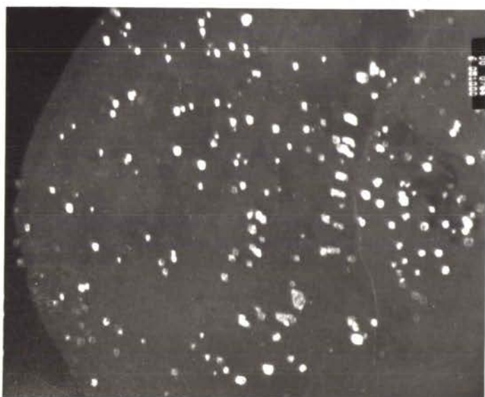
e - (x51 000) – Précipités intragranulaires de type M_{23}C_6 , t_m = 30 min
