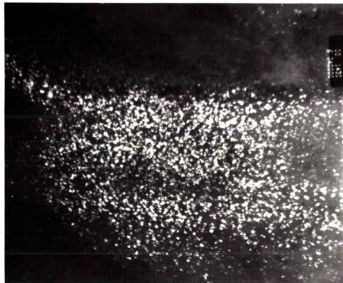
d - (x40 000) – Précipités de type M_{23}C_6 dont la densité dans le grain est relativement homogène, t_m = 300\ \text{min}
