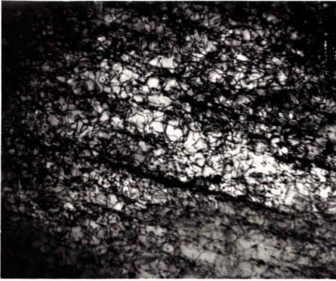
a - (x21 000) – Aspect de la sous-structure de dislocations t_m = 10\ 080\ \text{min}
