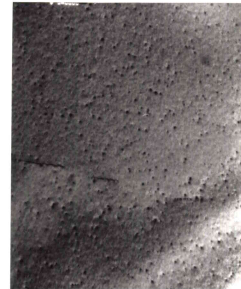
c) r_{\gamma'} \approx 3 \text{ nm} - (40 000)
