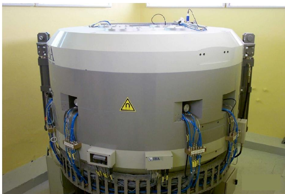
Figure 14 : Cyclotron installé au CERMEP, IBA 18/9 Cyclone (Ion Beam Application, Louvain-la-Neuve, Belgique).
