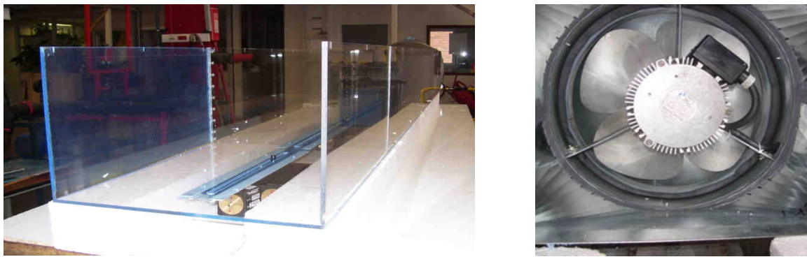
figure 4.3 - Photographie de la veine et du ventilateur
