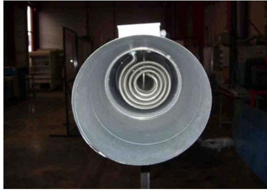
figure 4.5 - Photographie du système de chauffage de l'air
