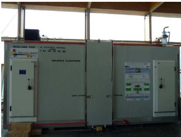
(a) Vue globale de l'enceinte climatique située au CRITT Bois d'Épinal : paroi testée dans la partie centrale de l'enceinte climatique
