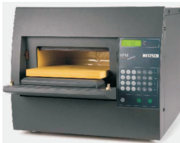
FIG. D.1 – Appareil de mesure de la conductivité thermique (HFM Lambda)
