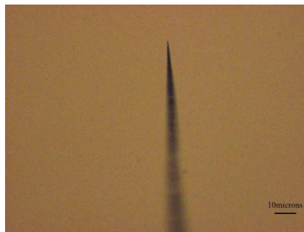
FIG. C.13: Pointe AFM en tungstène après attaque chimique, microscopie optique
