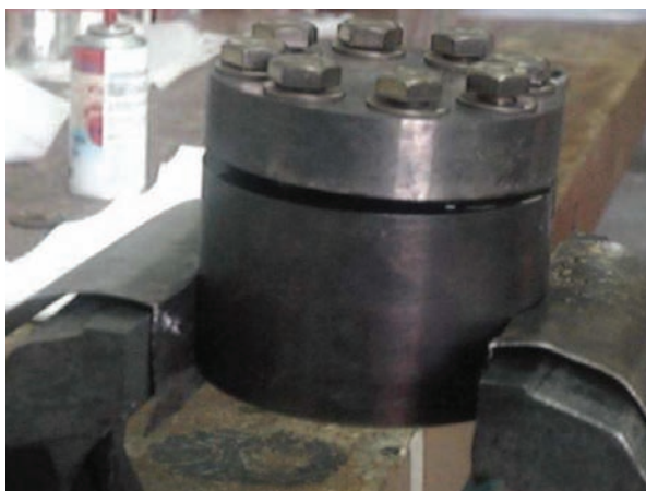
Figure 20 - Photo de l'autoclave à joint chaud chemisé en or développé par Nguyen-Trung (1980).
