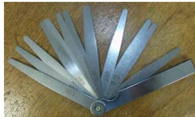
FIG. 4.28 – Jeu de cales de précision pour l'ajustement manuel de la distance inter-électrodes.
