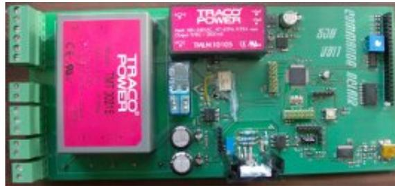
FIG. 4.20 – Photographie du contrôleur de circuit d'amorçage.
