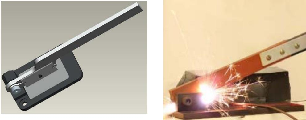
FIG. 4.2 – Arc provoqué par une guillotine. Photographie extraite de [JW03].
