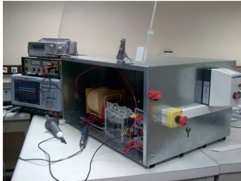
FIG. 4.7 – Photographie du banc de génération d'arc réalisé au laboratoire.
