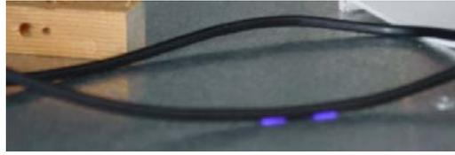
FIG. 4.35 – Décharge corona entre un câble et la masse.
