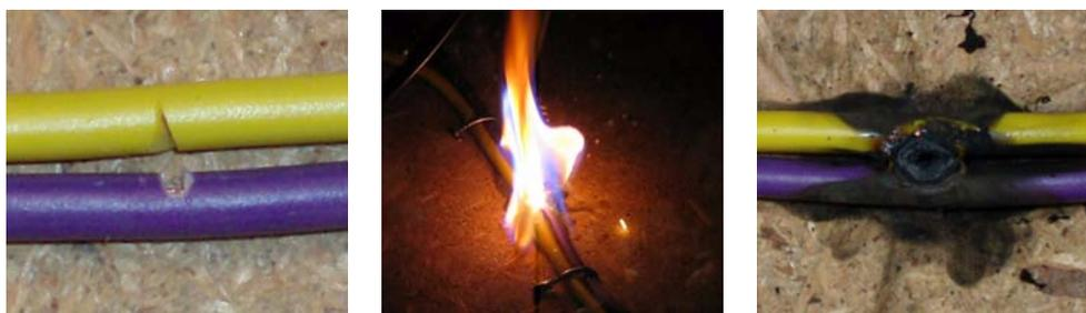
FIG. 4.34 – Exemple d'utilisation du GDARC avec des câbles.
