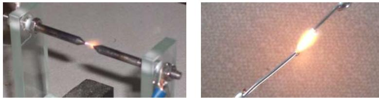
FIG. 4.32 – Influence de la géométrie des électrodes utilisées.
