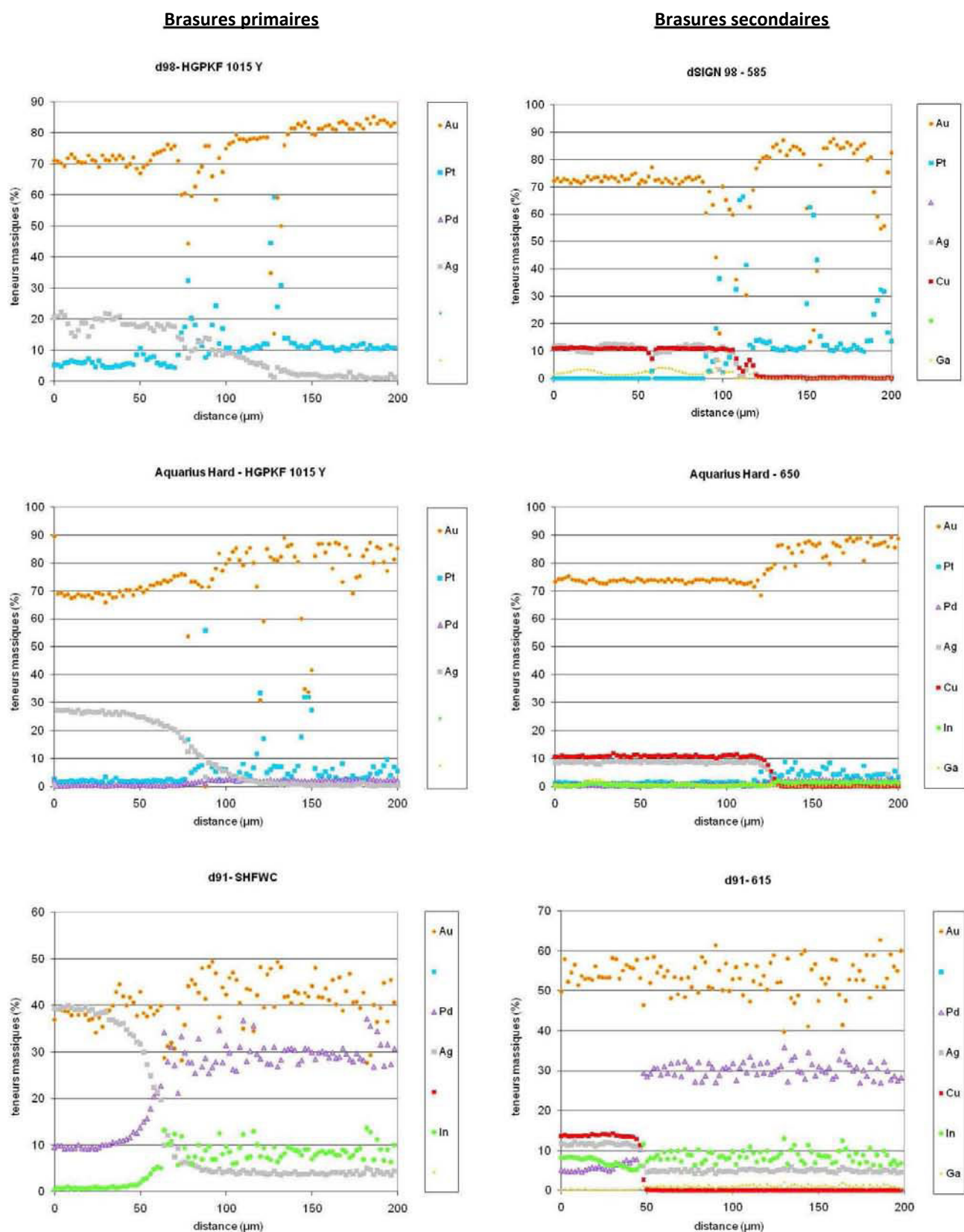
Figure 4.29: profils de concentration des éléments obtenus à la microsonde de Castaing depuis le centre de la brasure vers l'alliage parent pour les échantillons des alliages dSIGN 98, Aquarius Hard, dSIGN 91. et leur brasure primaire (à gauche) et secondaire (à droite)
