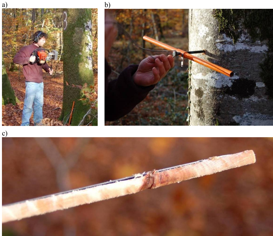
Fig. 16. Prélèvement d'une carotte de bois sur du hêtre : a) carottage au carotteur thermique, tarière de Pressler 40 cm, rayon intérieur 5 mm ; b) extraction de la carotte de la tarière ; c) vérification visuelle de la proximité du cœur et détection d'éventuelles anomalies (bois pourri, défauts de croissance).
