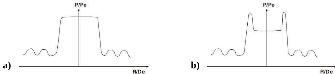
Figure 1.22 : Allure du profil de pression adimensionnée par la pression d'éjection P/P_e sur la surface impactée (en x=x_p ) par un jet sous-détendu en fonction de la position radiale r/D_e : (a) sans bulle de recirculation ; (b) avec la présence d'une bulle de recirculation à l'impact.
