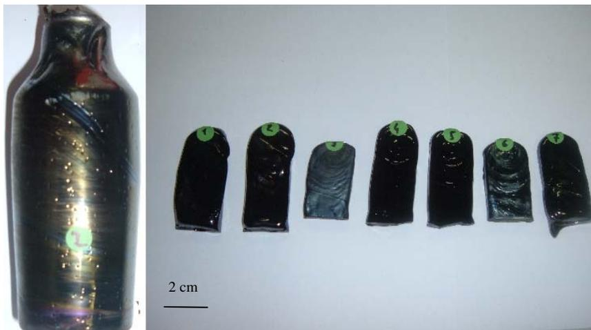
**Figure 24 : A gauche : bouteille façonnée dans un moule en graphite. Le goulot est ensuite scié et la bouteille est utilisée pour les expériences en présence d'un rayonnement UVC. A droite : série de barreaux utilisés pour les expériences sans irradiation UVC.**
