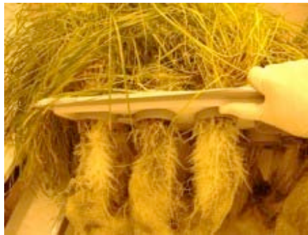
Figure 9 : Dispositif de culture hydroponique pour la production des exsudats racinaires
