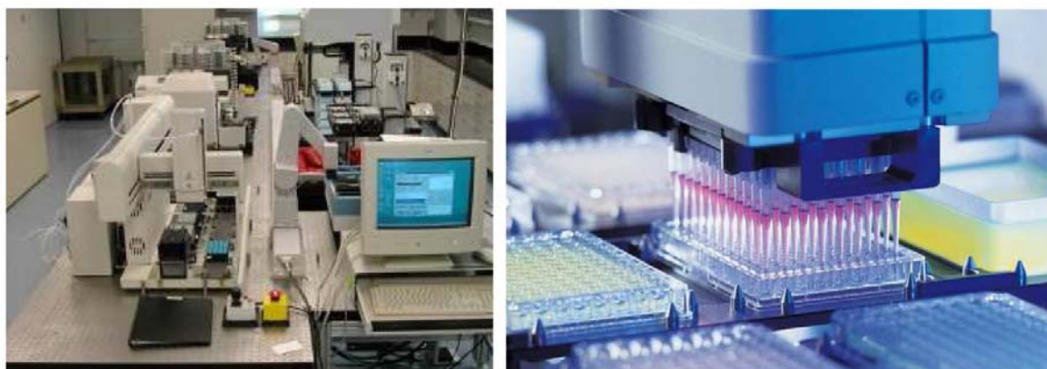
Figure 3 – Aperçu d'une plateforme de criblage haut-débit robotisé et d'une plaque 96 puits.
